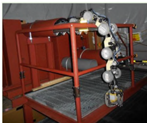
図 9 1号機PCV内部気中部調査 調査装置 25
