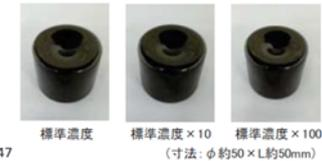
図4 ガラス試験片の均質性評価 (目視観察)
