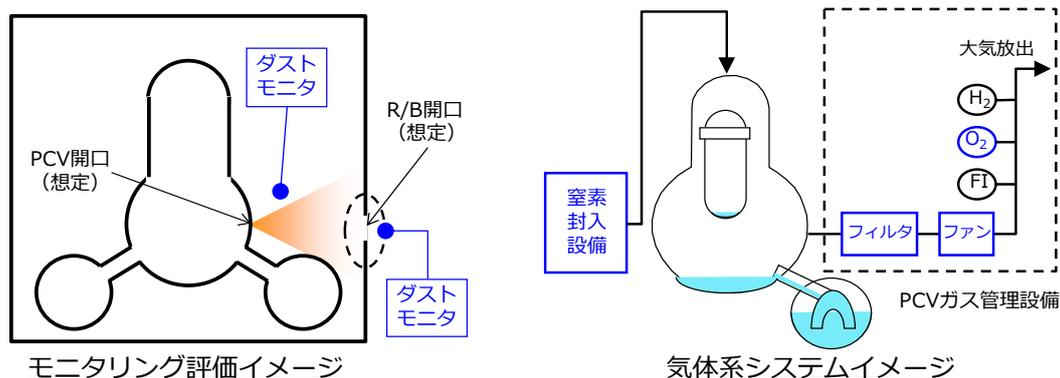
図 A7-3 小規模な燃料デブリ取り出し時の安全システム検討概要（東京電力提供）
