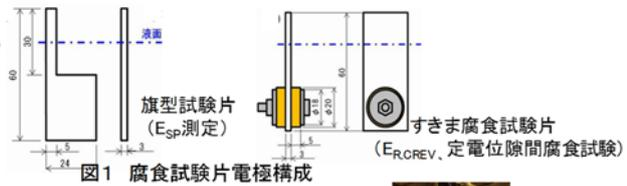
図1 腐食試験片電極構成
