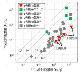
図20 瓦礫中の<sup>90</sup>Sr/<sup>137</sup>Csと放射能濃度比
