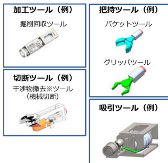
図 A7-9 把持、吸引、切断に関するツール（例）（東京電力提供）
