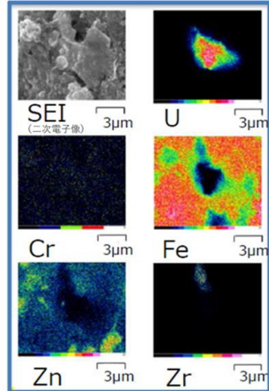
図1 1号機で採取された堆積物の元素分布
