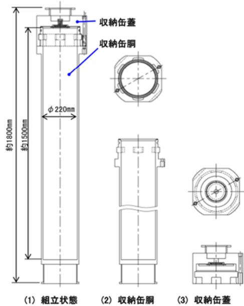
図1 収納缶の基本計画形状案 (簡易取付構造蓋[回転による蓋締め]、内径220mm)
