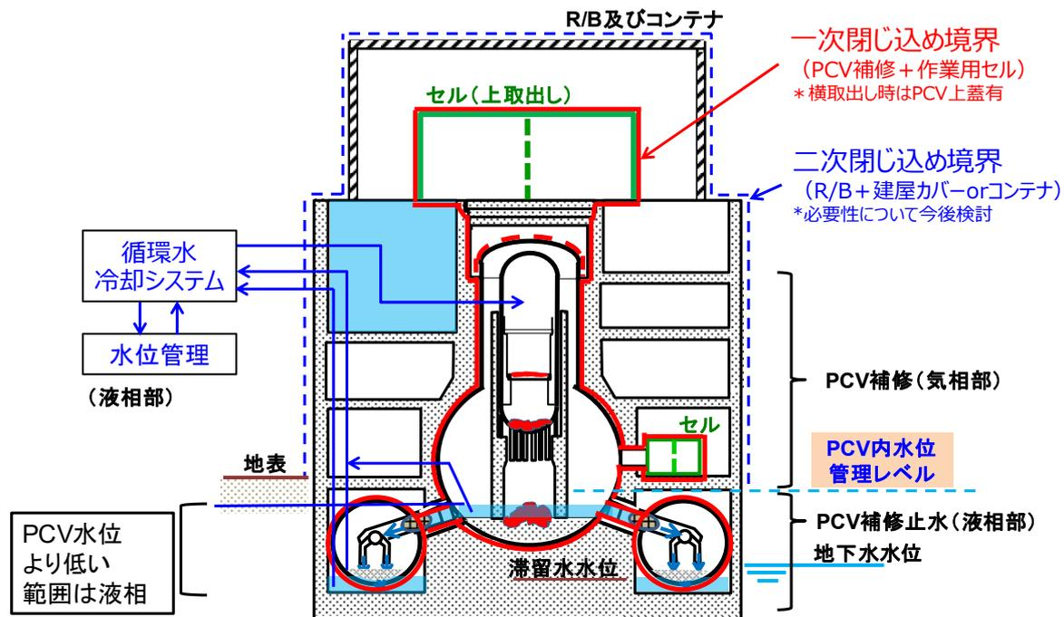
図 10 閉じ込め機能（液相部）の構築例
