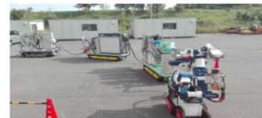
図2 上部階用除染装置
