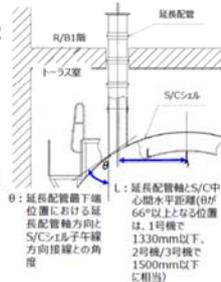
図2 S/C取水部構造の配置検討例
