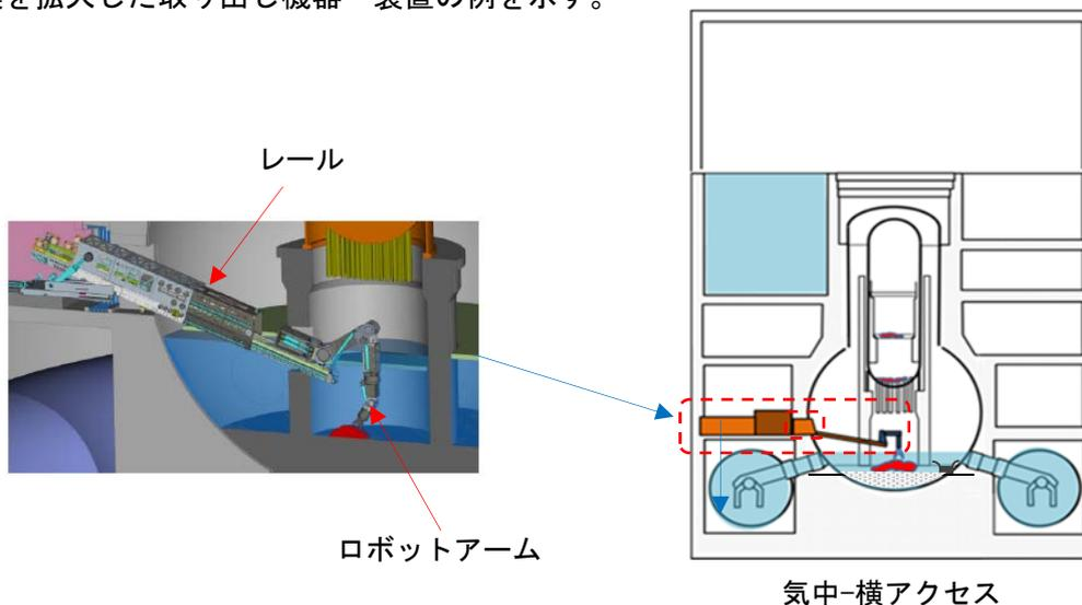
図 A7-10 規模を拡大した取り出し機器・装置に関する例（IRID 提供）
