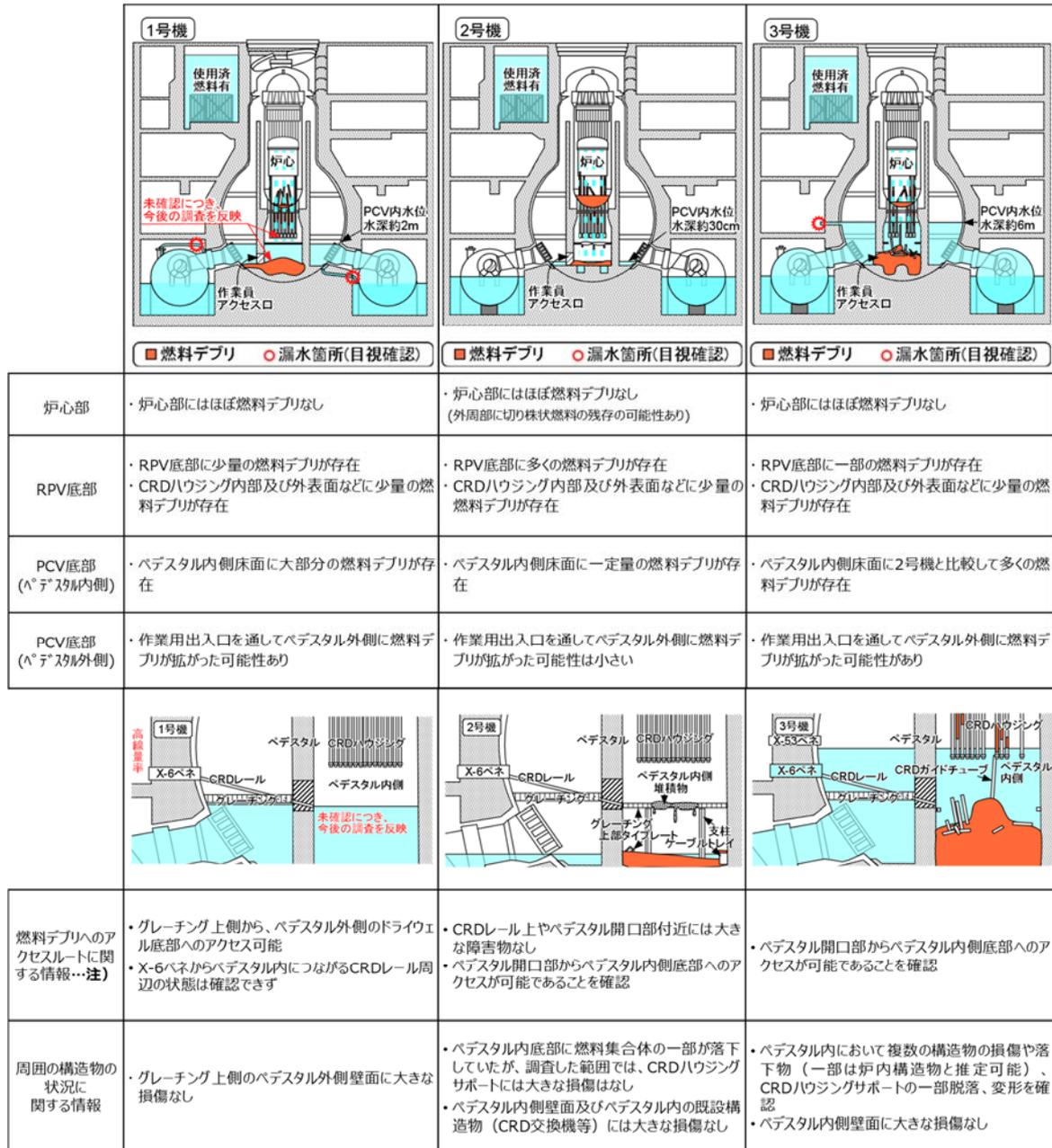
注) 横アクセスによる燃料デブリ取り出しのための有力なアクセスルートと考えられる、X-6ベネからベデスタル内側へ至るルートに、落下物等による支障がないかを判断するための情報として、これまでの内部調査で確認された内容を記載。PCV内の燃料デブリ取り出しのアクセスルートについては、機器ハッチ等からのアクセスルートを廃炉・汚染水対策事業で検討中。1号機のX-6ベネの周りは高線量率であるため、作業環境整備が困難な場合は、規模の拡大時と同じアクセスルートとする可能性がある。なお、次の1号機の内部調査はX-2ベネからアクセスする計画で開発を進めている。
