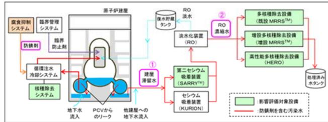
図3 腐食抑制システムの概念設計例
