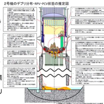
図1 燃料デブリ分布の推定図の例
