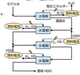
図7 燃料電池を用いた電解再結合法
