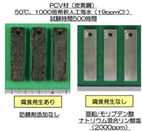
図1 腐食抑制策の開発状況
