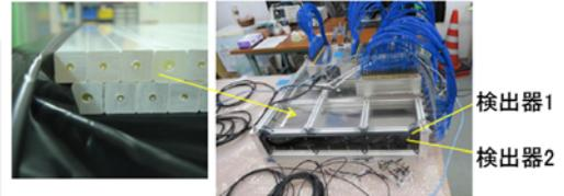
図2 小型化した透過法測定装置
