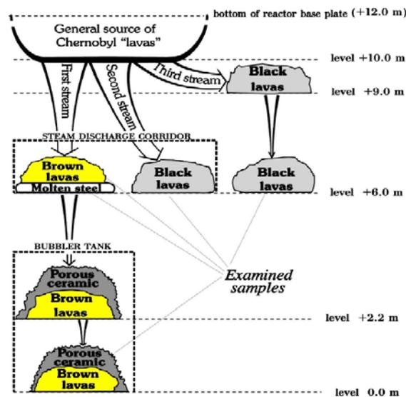
図 A8-6 チェルノブイリ原子力発電所 4 号機における燃料デブリ分布<sup>67</sup>
