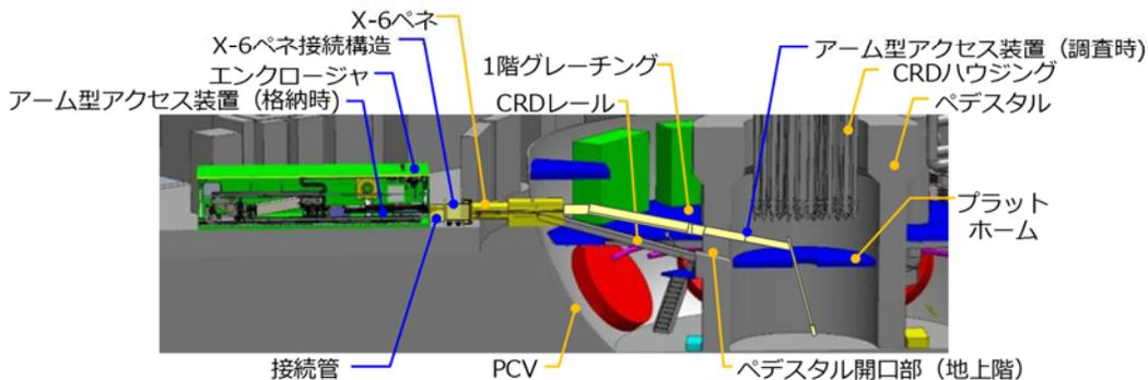
図 A7-6 X-6 ペネトレーションを用いた場合の小規模な燃料デブリ取り出しのイメージ
