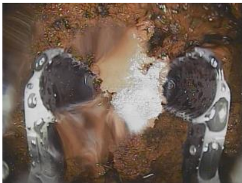
図 2号機の堆積物接触調査※
