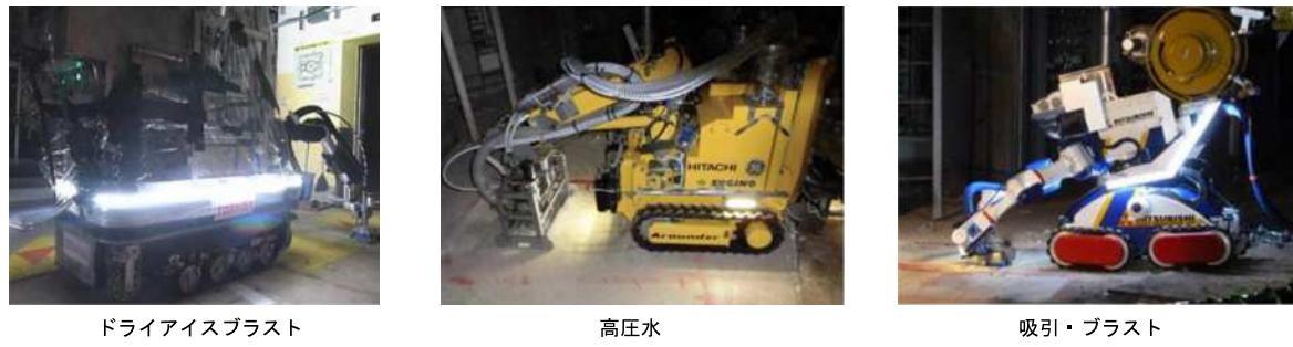
図 4.3.3-11 低所用除染装置 (IRID 提供)
