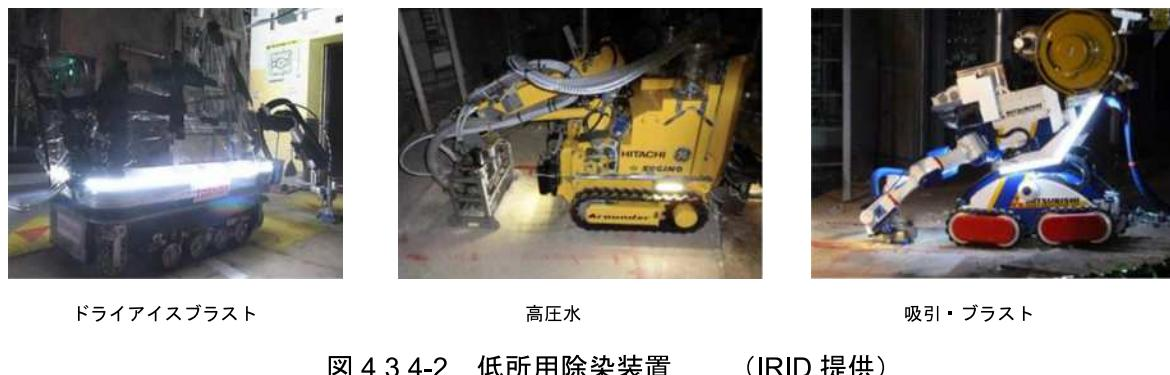
図 4.3.4-2 低所用除染装置 (IRID 提供)
