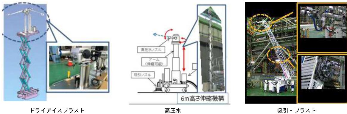
図 4.3.3-12 高所用除染装置 (IRID 提供)
