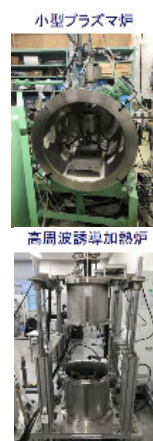
図2 試験に用いる溶融炉の例
