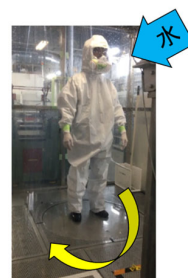
図2 試作した防護服の防水性能試験の様子
