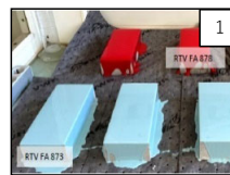
レーザー切削前の模擬燃料デブリへの飛散抑制材塗布(写真①)。 塗布材の飛散抑制効果評価のための気中飛散粒子生成物の監視(写真②)。
